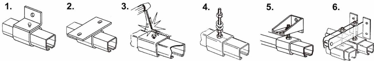
**Wichtig für alle Muffen! Befestigung an der Laufschiene alle 750 mm, z.B. siehe unten:**
